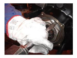
Le matériau de la rondelle doit être coupé le long du bord de l'extrémité plate de l'écrou et formée progressivement au-dessus de la longueur restante de la fente de façon à résister au desserrage de l'écrou dans le cas d'une perte de couple (voir les exemples ci-dessous).
