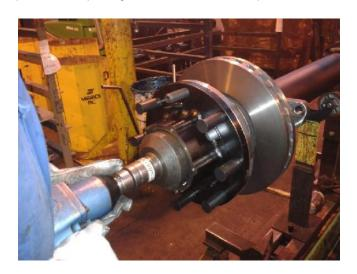
En utilisant une clé dynamométrique appropriée, appliquer un couple de serrage final d'une valeur de 750/800 Nm.
