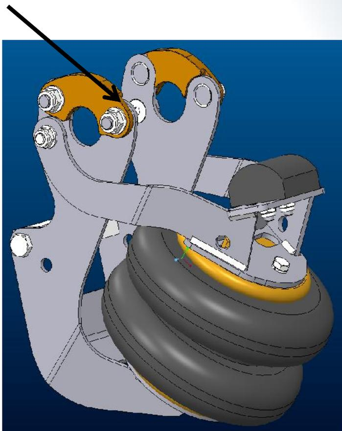
Un nouveau système de relevage a été développé pour l'ensemble des suspensions à bras intégrés type «CS» (Euroflex).
