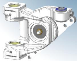
A compter de Décembre 2016, les essieux auto-suiveurs de la série LM avec frein à disque, sont fabriqués dans une nouvelle version qui dispose d'un nouveau groupe de direction, optimisé et allégé.
